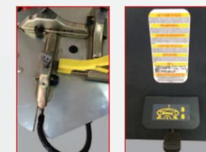
Станок TC 555 IT L-L оснащен системой взрывной накачки бескамерных шин с ресивером 24 л, что позволяет значительно уменьшить время работы с бескамерными шинами.
