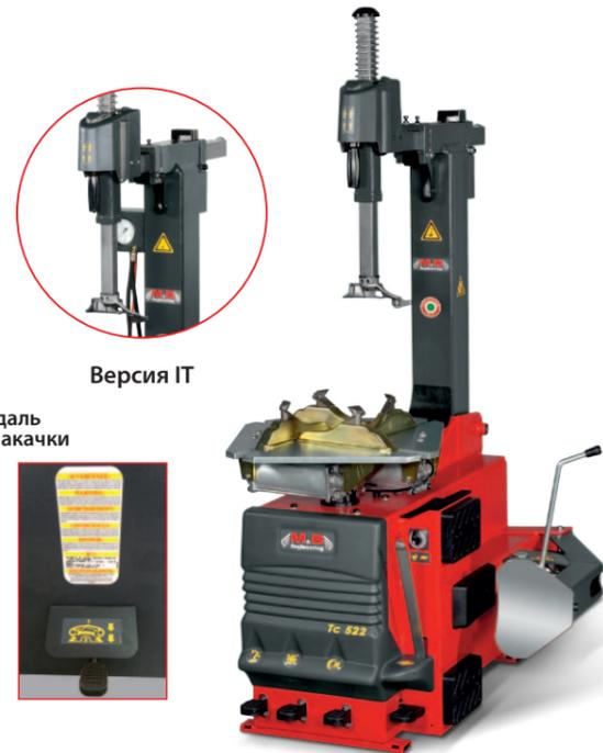
Станок TC 522 IT оснащен системой взрывной накачки бескамерных шин с ресивером 24 л, что позволяет значительно уменьшить время работы с бескамерными шинами.
