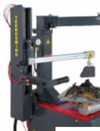
Пневматическое устройство TECHNOSWING для низкопрофильных шин "третья рука" ТОЛЬКО для полуавтоматических станков М&В.
