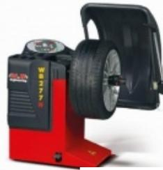
М&В WB277 автоматический балансировочный станок (3 параметра автоматом), масса колеса до 70 кг.
