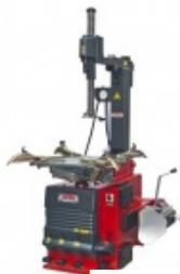
Автоматический шиномонтажный стенд с модулем взрывной накачки M&B TC 528IT для монтажа и демонтажа колес легковых автомобилей, мотоциклов и легких грузовиков с диаметром диска от 10" до 31".
