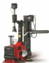
M&B TC555 L-L 380B Станок шиномонтажный автоматический от 10 до 30", система LL (Lever Less)- позволяет работать без использования монтажки, крепление колес за центральное отверстие, взрывная накачка
